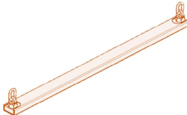
Les barres traversantes sont principalement conçues pour être utilisées dans des halls à température ambiante normale. Pour soulever une machine, il faut toujours utiliser deux barres traversantes en même temps.
