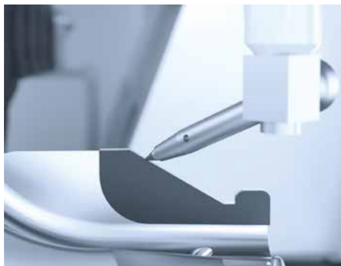
/// MEDIÇÃO DA ARESTA DO PCD para um processamento preciso
