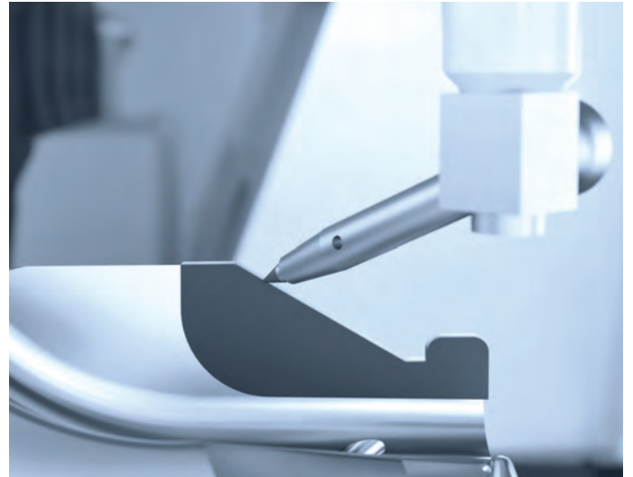
/// 刀刃测量装置 确保精确加工
