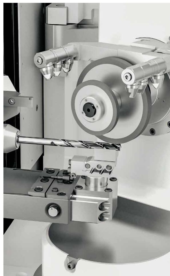
//////// 自動ストローク付きの振れ止めが、刃長の長い工具の卓越した研磨結果を実現
