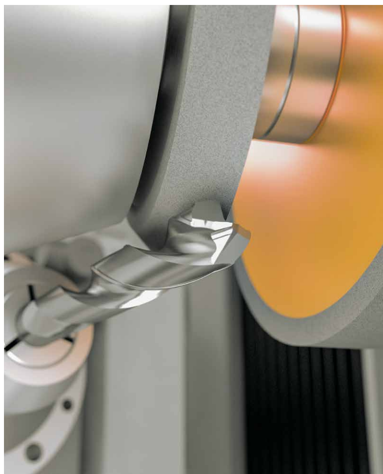
//////// 超硬ドリルの加工
