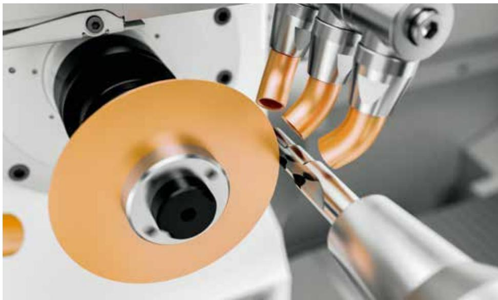
///// BEARBEITUNG EINES PKD-STUFENBOHRERS
