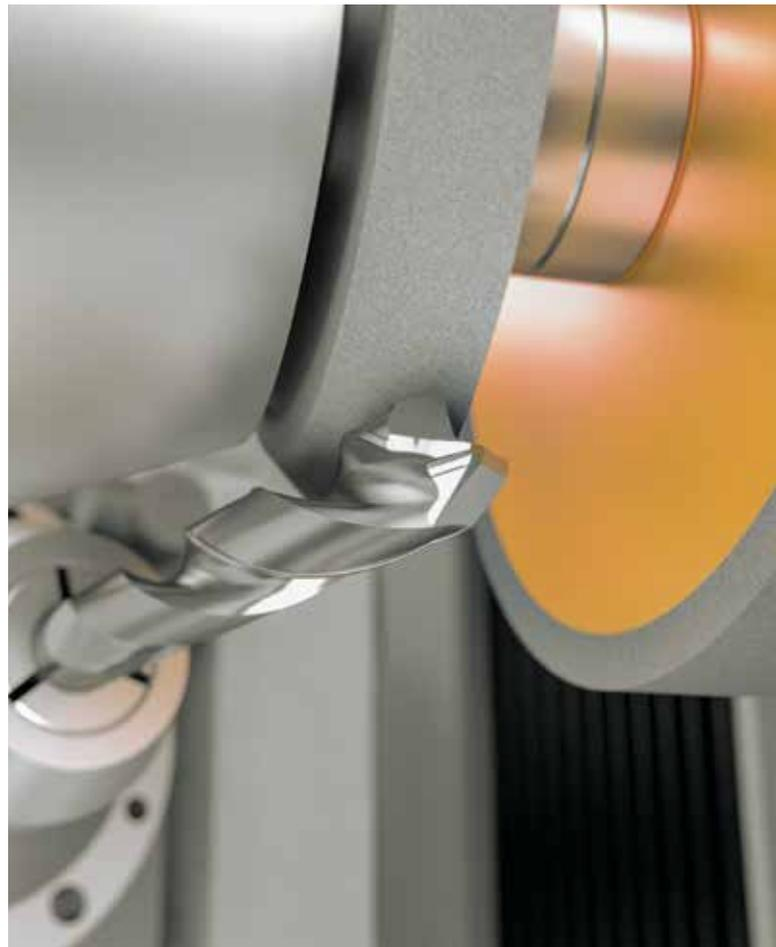
//////// BEARBEITUNG VON HARTMETALL-BOHRERN
