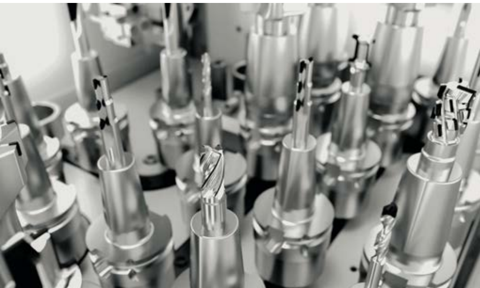
////// 采用紧凑结构的链式工件库 HC 4和HC 4 plus
