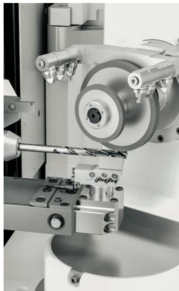
////// 支撑托架自动升降，确保在较长刀具上 也能达到最佳磨削结果
