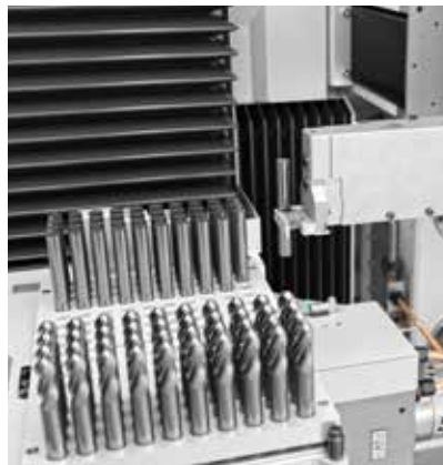
///// CARGADOR INTERNO con espacio para hasta 300 piezas sin mecanizar o herramientas
