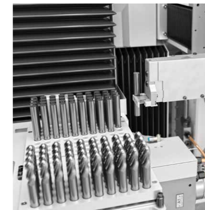
//////// 内蔵式パレットローダー 最大 300 個のプランクもしくは工具を 搭載可能。
