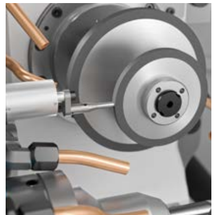
////// 砂轮测头 砂轮测量和磨损控制
