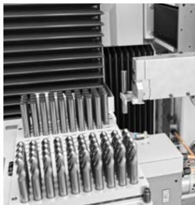
////// 内部托盘装载机可容纳最多300个 毛坯或刀具
