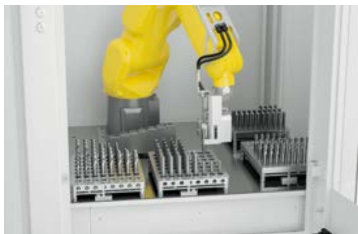
// ROBOT ZE SWOBODNYM RAMIENIEM dla zapewnienia maksymalnej pojemności dla narzędzi trzpieniowych
