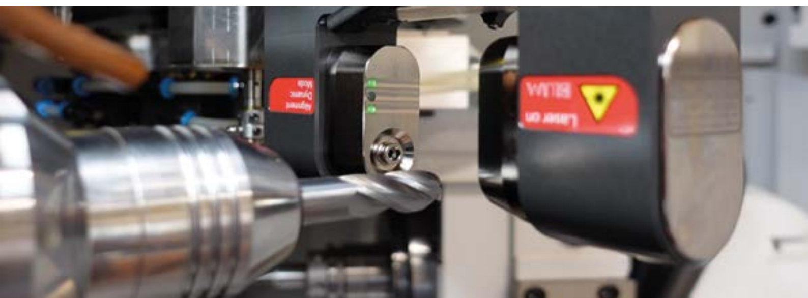
// LASEROWY SYSTEM POMIAROWY do wysoce dynamicznych i bezdotykowych pomiarów w jednej operacji zaciskania
