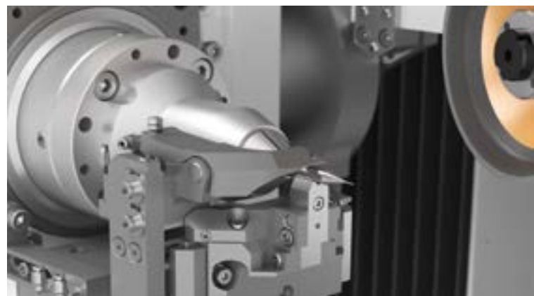
// PODTRZYMKĄ DO TRZPIENI zapewnia idealną precyzję w mikronarzędziach
