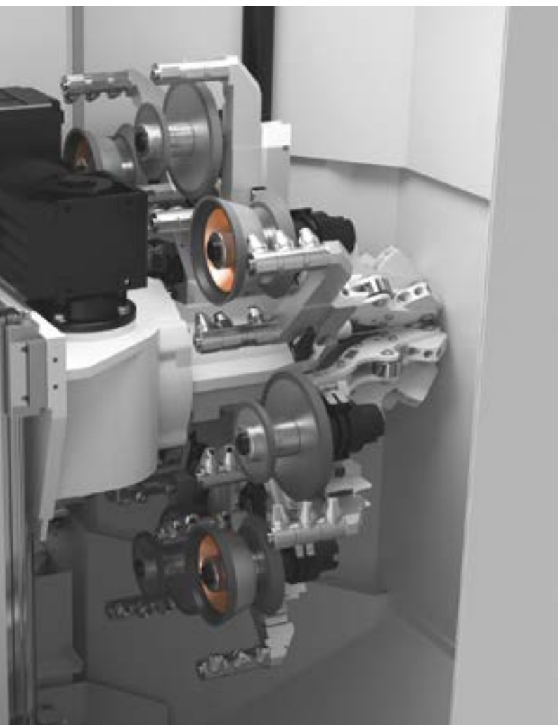
// ZMIENIARKA NA 8 PAKIETÓW ŚCIERNIC do efektywnej zmiany ściernic i redukcji czasów przejściowych
