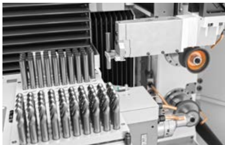
// WEWNĘTRZNY MAGAZYN PALETOWY z miejscem na nawet 300 narzędzi trzpieniowych
