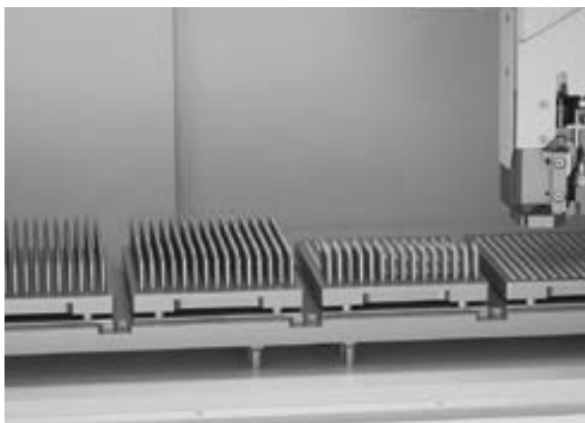
// MAGAZYN PALETOWY HP 170 do szybkiego podawania nawet 900 narzędzi trzpieniowych
