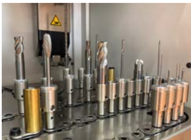
// MAGAZYN ŁAŃCUCHOWY HC 4 i HC 4 plus na różne narzędzia trzpieniowe i HSK
