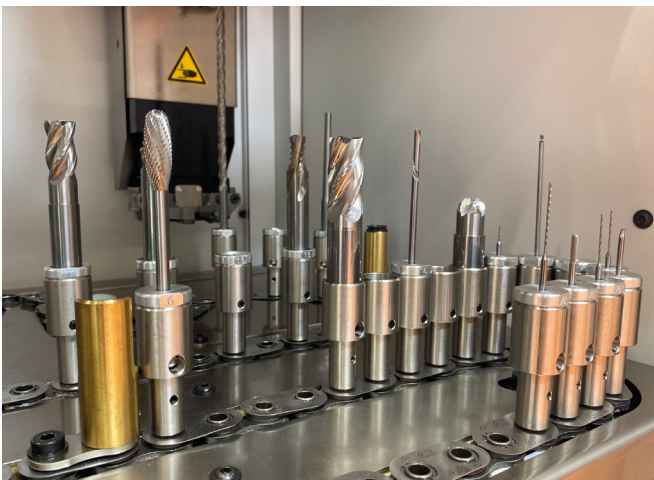
// チェーンマガジン HC 4 & HC 4 plus 多様なシャンク工具およびHSK工具に対応
