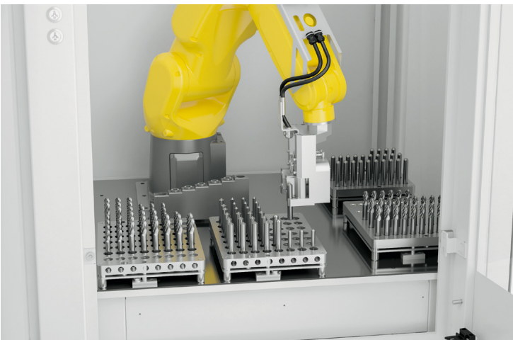
// フリーアームロボット 最大容量と多様なシャンク工具に対応
