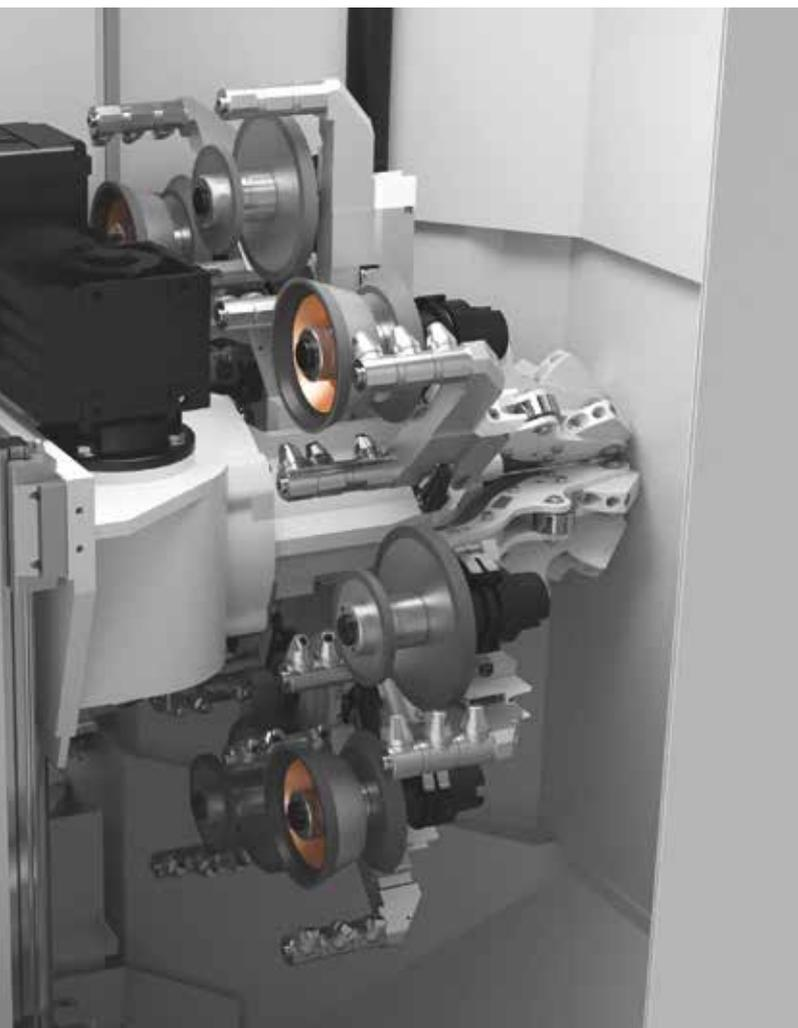
// DISPOSITIVO DI CAMBIO DELLE MOLE DI AFFILATURA A 8 POSIZIONI
