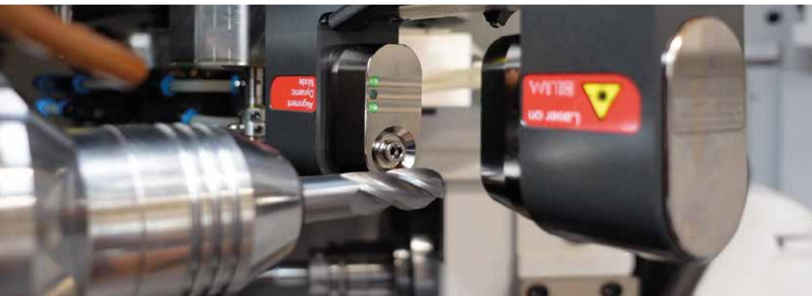
// SISTEMA DI MISURAZIONE LASER
