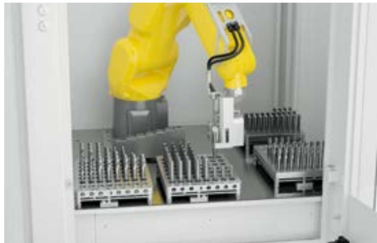
// CHARGEUR À ROBOT MULTI-AXES
