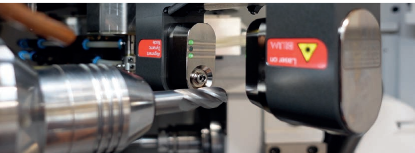
// 激光测量系统 支持单次装夹下高动态非接触式测量
