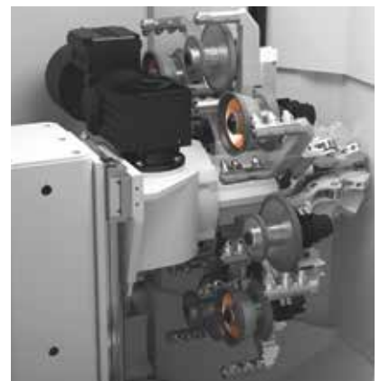
/////// TROCADOR DE REBOLOS ÓCTUPLO para trocas de rebolos eficientes e redução dos tempos de inatividade
