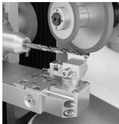
/////// BISEL COM CURSO AUTOMÁTICO garante um resultado de afiação ideal em ferramentas mais longas
