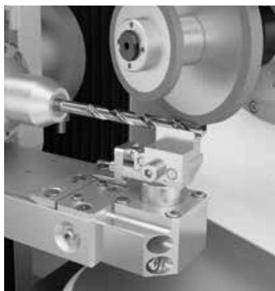
////// LUNETA CON ELEVACIÓN AUTOMÁTICA para un resultado óptimo del afilado con herramientas largas
