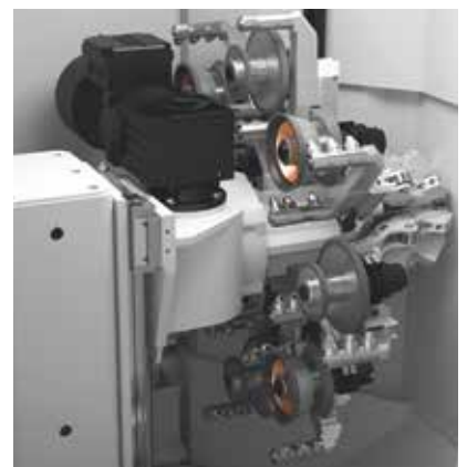
////// CAMBIADOR DE MUELAS ABRASIVAS DE 8 POSICIONES para un eficiente cambio de herramienta y reducción de los tiempos tecnológicos auxiliares
