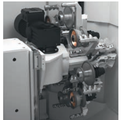
////// 8工位砂轮库 实现高效的砂轮更换，减少非生产时间
