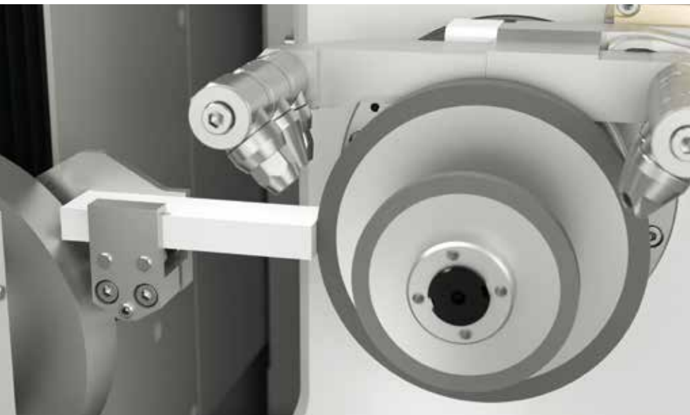
////// UNITÀ DI ABRASIONE per ripristinare strato abrasivo
