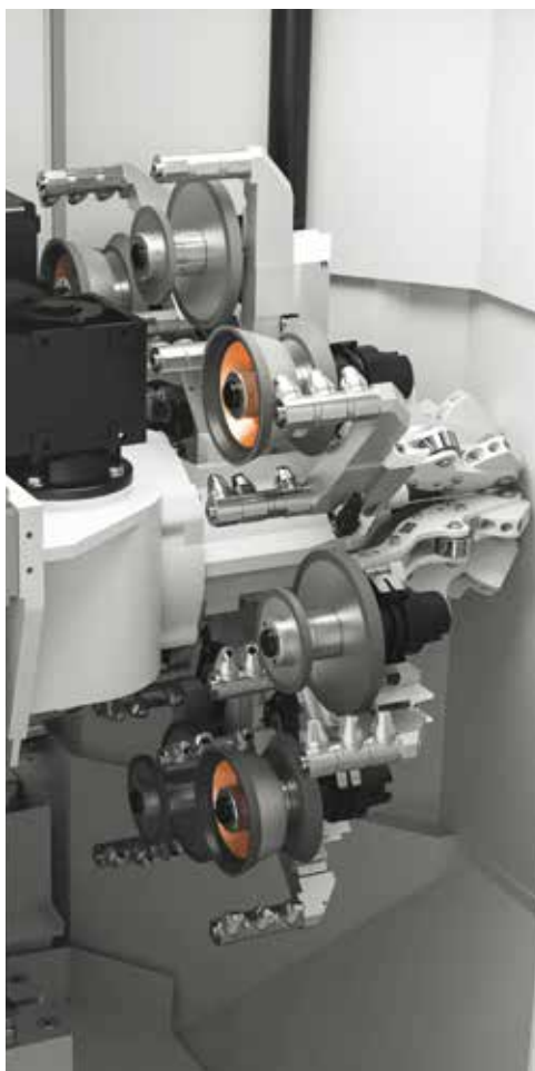
//////// DISPOSITIVO 8X PER CAMBIO MOLE DI AFFILATURA con ugelli per il refrigerante
