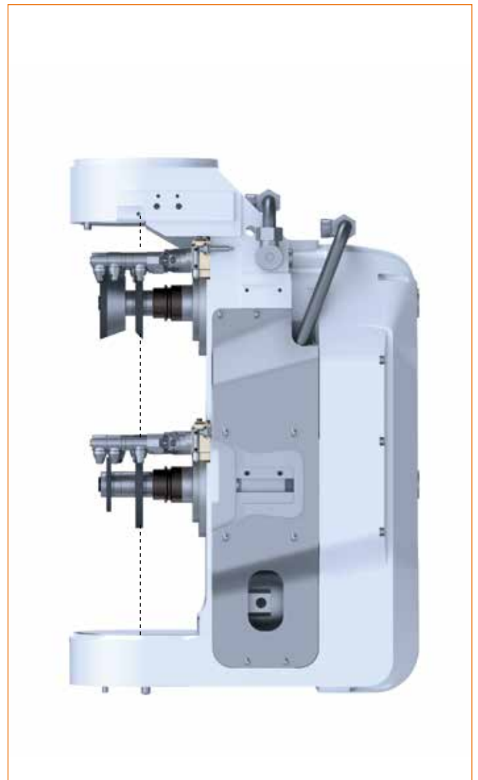
/// CENTRE DE ROTATION DES TRAINS DE MEULES au centre de l'axe C
