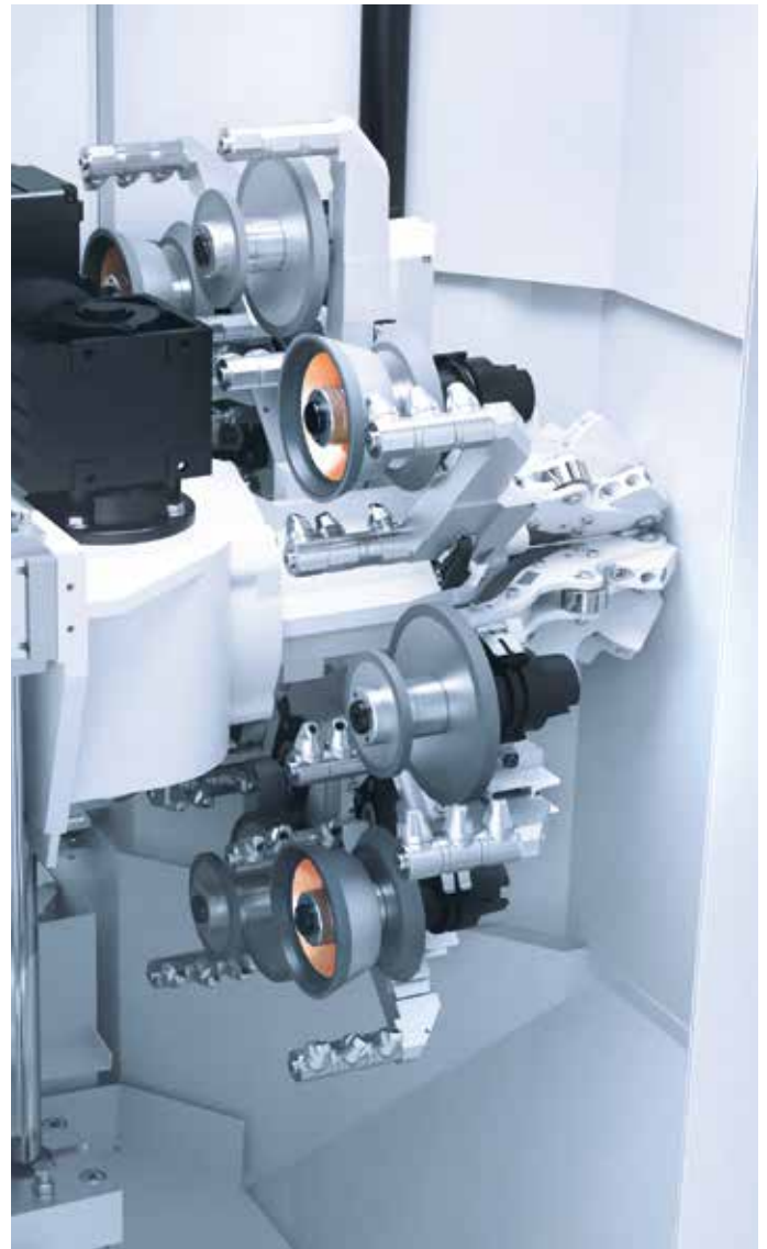
/// CHANGEUR DE MEULES À 8 POSITIONS avec buses de liquide d'arrosage embarquées
