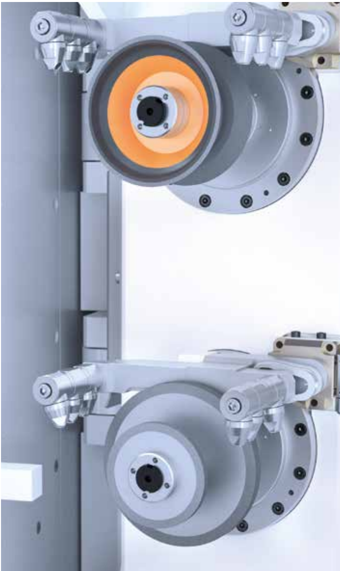
/// 冷却液喷嘴 确保理想的冷却液供应
