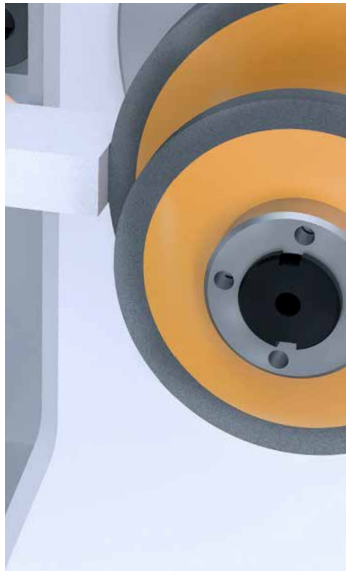
/// 砂轮开刃装置 解决砂轮堵塞问题
