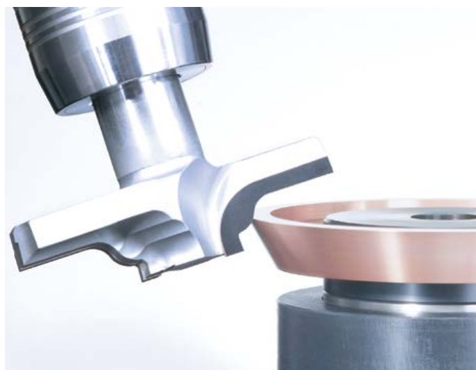
/// EROSÃO COM ELETRODO ROTATIVO DE UMA FRESA PERFILADA
