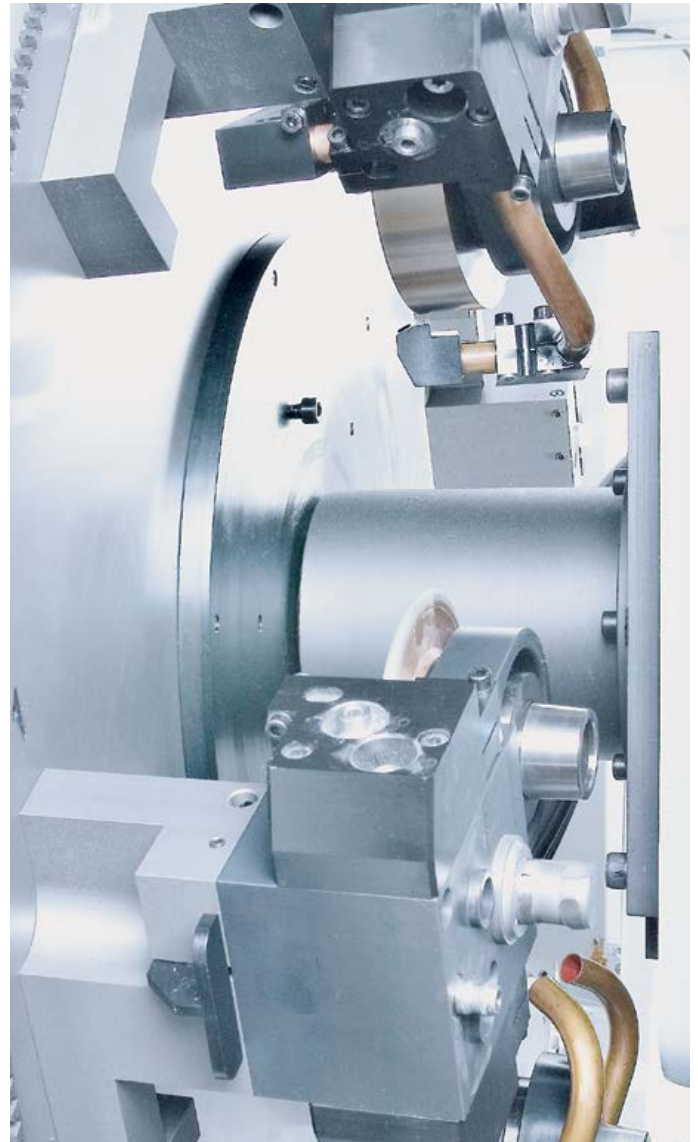
/// MAGAZINE COM CAPACIDADE PARA 6 ELETRODOS OU REBOLOS com diâmetro até 200 mm
