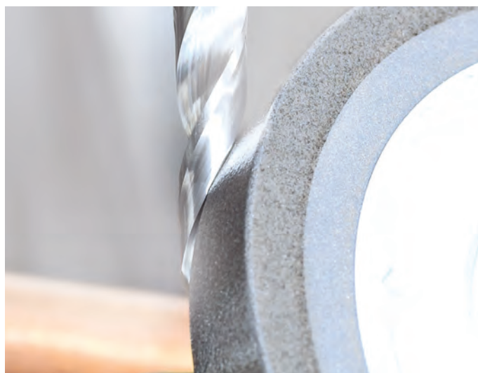
/// AFFILATURA DELLA SCANALATURA di una punta elicoidale in PCD
