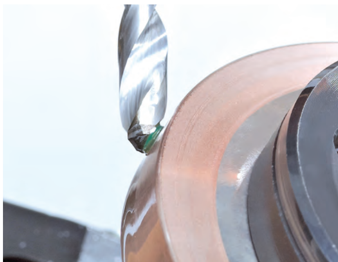
/// ELETTOEROSIONE DELLA SCANALATURA di una punta elicoidale in PCD
