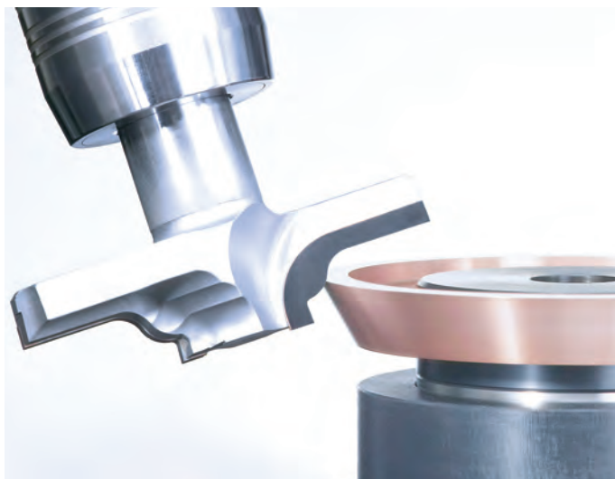
/// ELETTROEROSIONE DI UN PEZZO PROFILATO
