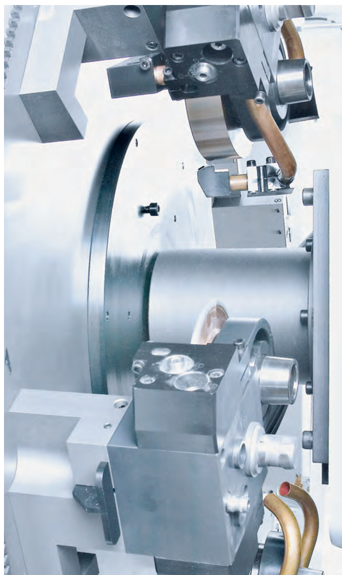
/// CHANGEUR D'ÉLECTRODES / MEULES 6 POSITIONS électrodes / meules jusqu'à 200 mm de diamètre
