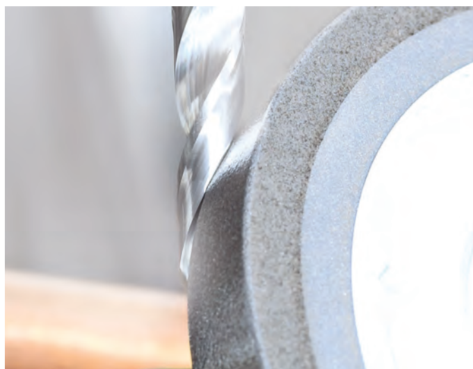
/// AFILADO DE BROCAS de una punta helicoidal de PCD
