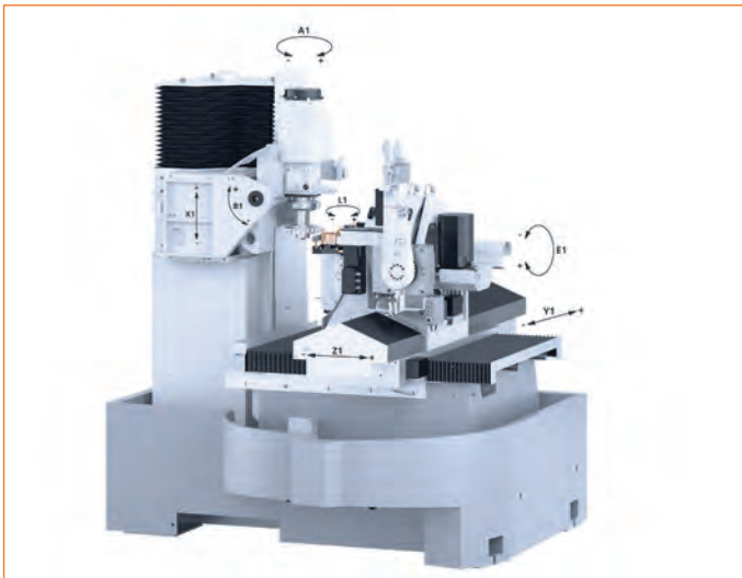
/// MÁXIMA FLEXIBILIDAD GRACIAS A LOS 6 EJES CONTROLADOS POR CNC
