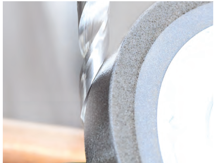
/// 磨削排屑槽 PCD麻花钻
