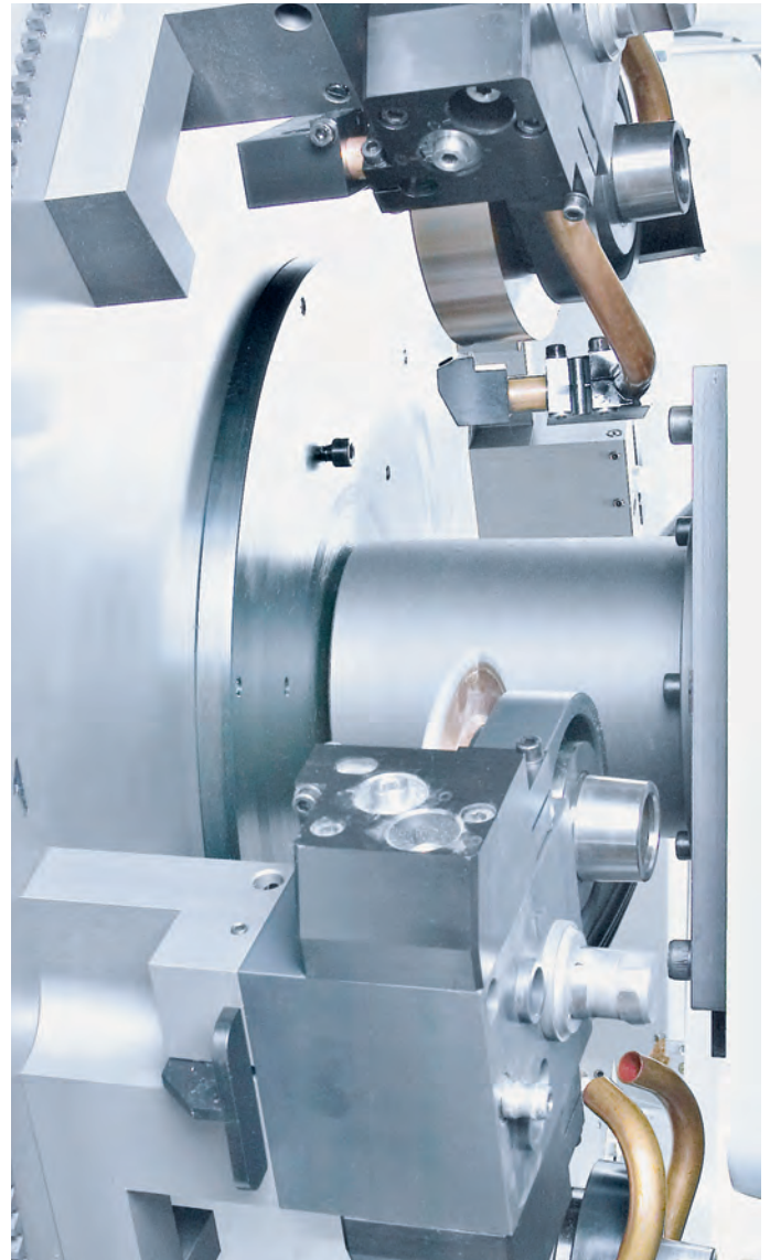
/// 6-FACH WERKZEUGSPEICHER für Werkzeuge bis 200 mm Durchmesser
