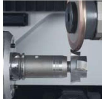
Erodieren eines Profilfräasers mit der Umfangscheibe.
