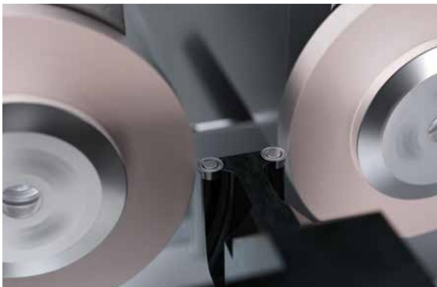
/////// MEDIÇÃO E RETIFICAÇÃO AUTOMÁTICA DOS ELETRODOS DE EROSÃO
