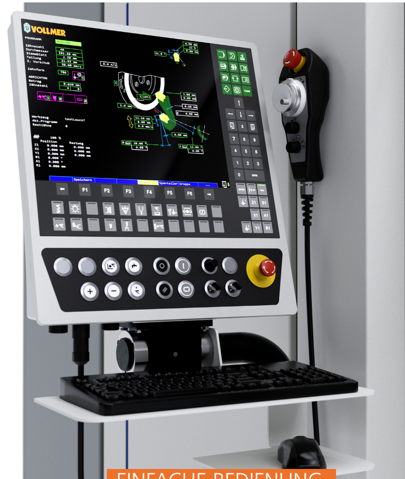
///// BEDIENPULT hochwertiges LCD-Display mit Touchscreen und Handbediengerät
