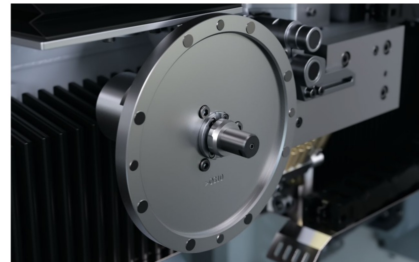
//////// ZENTRUMSBREMSE für Sägeblätter mit Beschichtung
