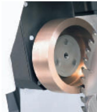
Arbeitsstellung der Erodierscheibe am Umfang des Sägeblatts
