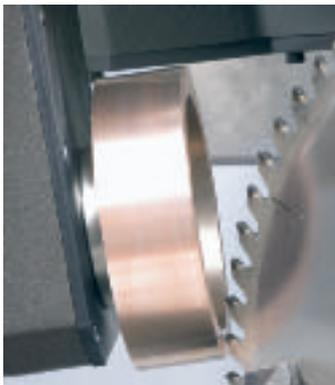
Arbeitsstellung der Erodierscheibe an der seitlichen Fase des PKD- Sägeblatts
