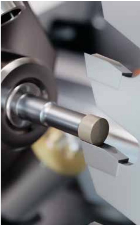
//////// ЗАТОЧКА ВОГНУТОЙ ПЕРЕДНЕЙ ГРАНИ
