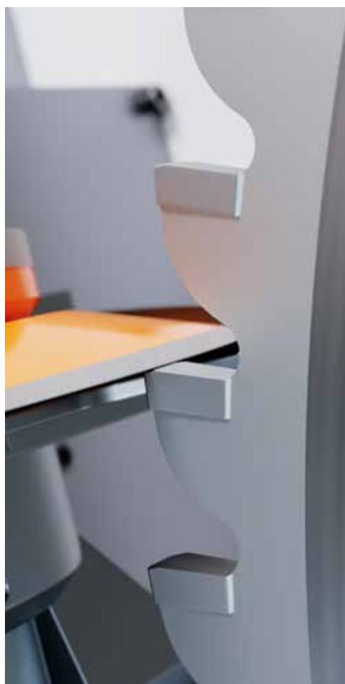
////// ОБРАБОТКА ПЕРЕДНЕЙ ГРАНИ С ОТРИЦАТЕЛЬНЫМ УГЛОМ
