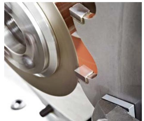
Bearbeitung der Spanteilerrille.
