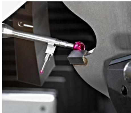
Der standardmäßig integrierte Messtaster nimmt alle relevanten Parameter wie Schnittbreite, Stammblattdicke und Spanwinkel auf.
