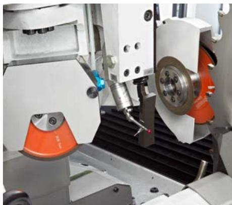
2 Hauptspindeln mit bis zu 3 Werkzeugen und dem zentral angeordneten Messsystem.
