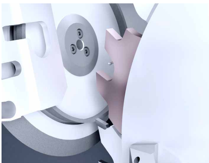
/// ОБРАБОТКА ЗАДНЕЙ ГРАНИ фланцевой пилы лесопильной промышленности
