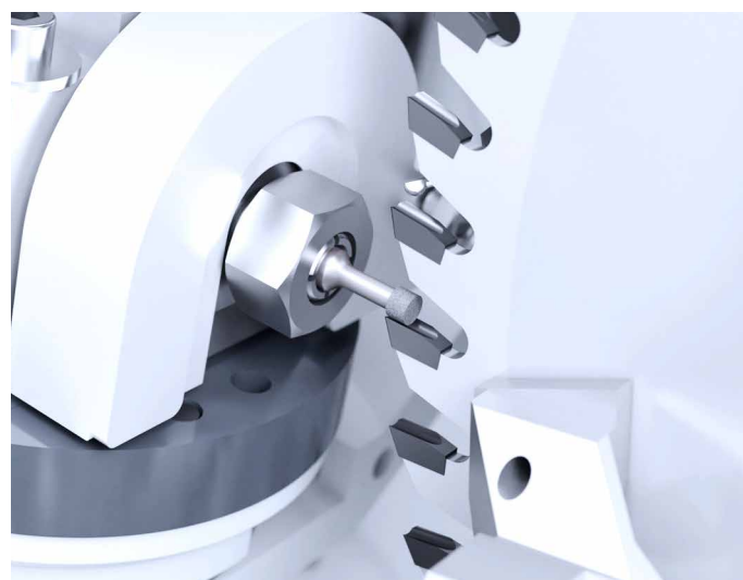
/// ОБРАБОТКА ВОГНУТОЙ ПЕРЕДНЕЙ ГРАНИ для повышения качества результатов при изготовлении мебели (опционально)
