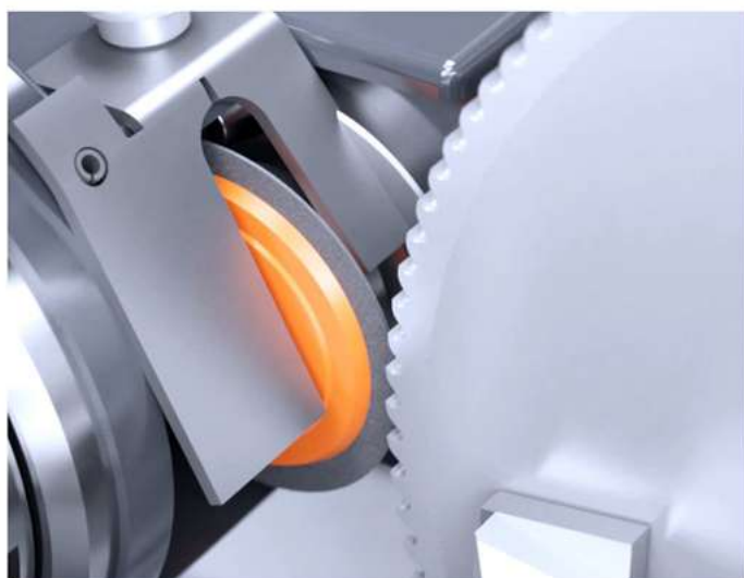
/// OSTRZENIE ŁAMACZY WIÓRA NA PIŁACH z wykorzystaniem ściernicy 50mm
