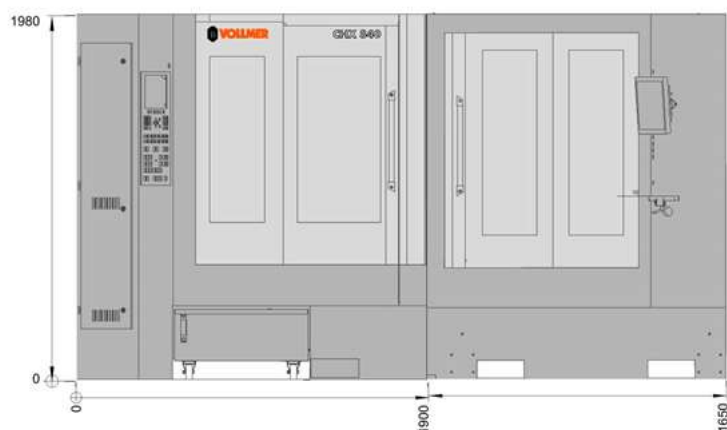
/// WYMIARY URZĄDZENIA CHX 840 WRAZ Z SYSTEMEM HS
