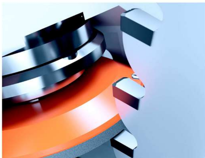
/// OSTRZENIE ZĘBÓW Z UJEMNYM KĄTEM NATARCIA
