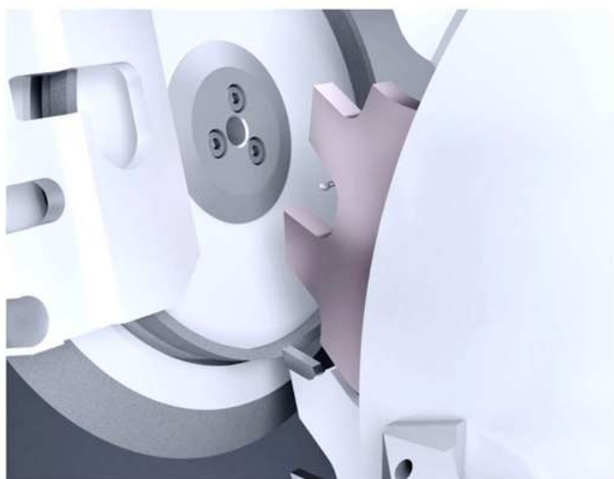
/// SZLIFOWANIE GRZBIETU ZĘBA piła z modułem segmentowym dla przemysłu tartaczego
