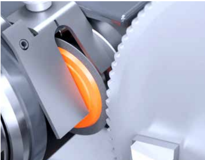
/// 鋸の溝入れ加工 50 mm 研磨砥石使用
