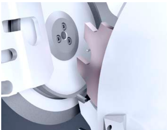
/// 齿顶刃磨 针对林业锯片的掉齿现象
