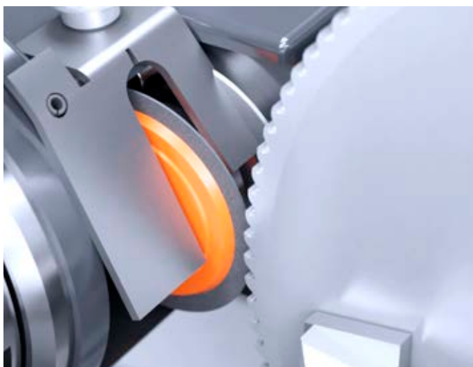
/// 针对锯片的分屑槽加工 采用50 mm砂轮
