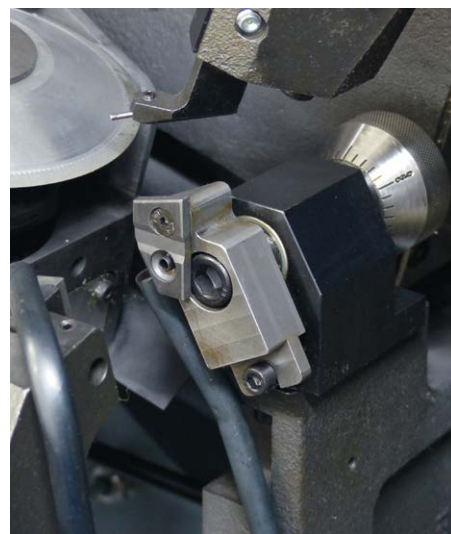
/// AJUSTE DA ESPESSURA DA LÂMINA Afição simétrica através do ajuste da espessura da lâmina.
