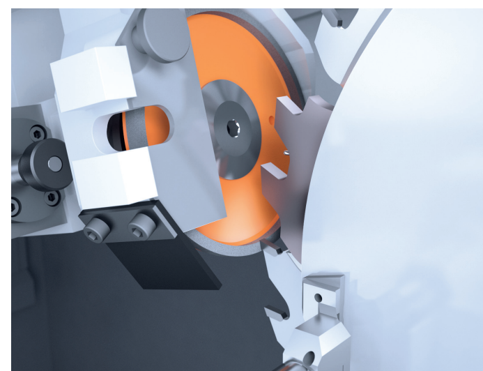
/// ОБРАБОТКА ЗАДНЕЙ ГРАНИ фланцевой пилы лесопильной промышленности
