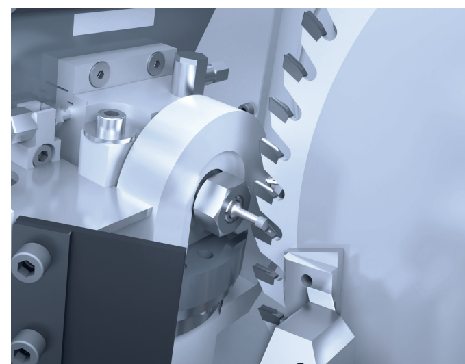
/// ОБРАБОТКА ВОГНУТОЙ ПЕРЕДНЕЙ ГРАНИ для улучшения результатов при изготовлении мебели
