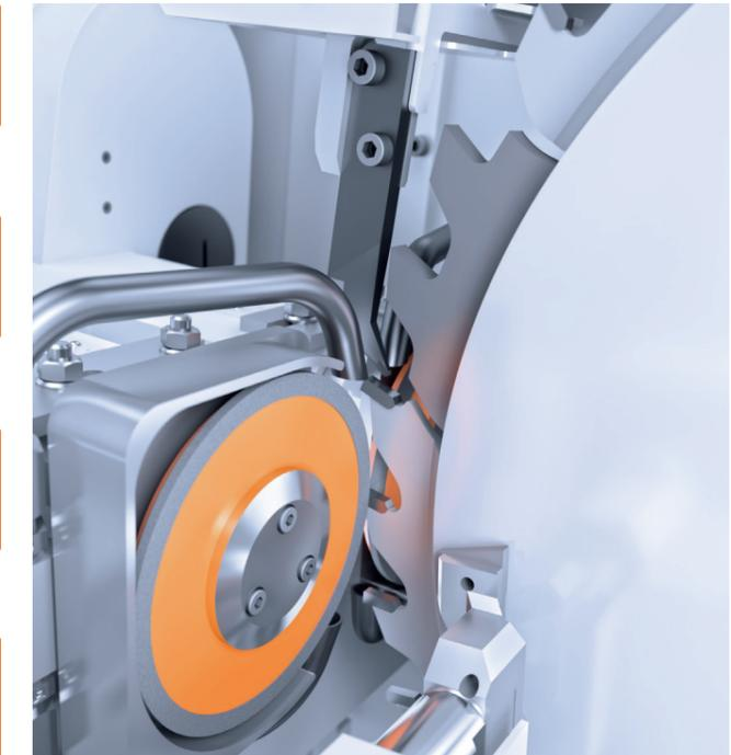
/// MECANIZADO DE UN SEGMENTO DE ARRANQUE DE VIRUTAS de la industria de aserraderos
