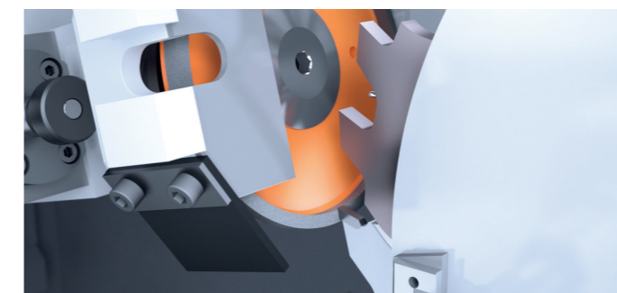
/// ОБРАБОТКА ЗАДНЕЙ ГРАНИ фланцевой пилы лесопильной промышленности
