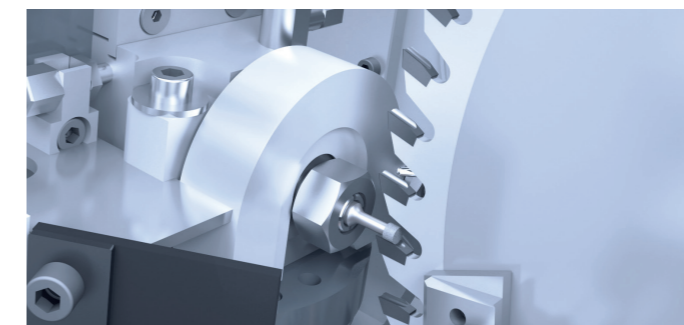
/// ОБРАБОТКА ВОГНУТОЙ ПЕРЕДНЕЙ ГРАНИ для улучшения результатов при изготовлении мебели
