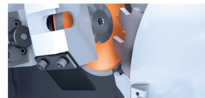
/// AFFÛTAGE DU DOS segment de déchiqueteur de l'industrie du sciage
