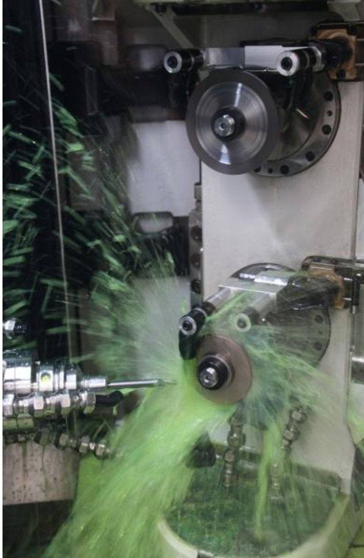
Bildtext: Die Vollmer Maschine VHybrid 260 ermöglicht durch zwei Spindeln eine Mehr-Ebenen-Bearbeitung, wobei sich die untere Spindel zum Schleifen und zum Erodieren eignet.
